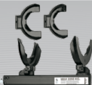
Ściskacz sprężyn kolumn McPhersona komplet: 2 pary łap, Ø 80-145 mm, 2 pary łap Ø 145-195 mm; max siła ściskania do 22.500 N
